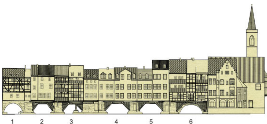
Bild 5. Ansicht der Krämerbrücke mit Nummerierung der instandgesetzten Gewölbe
